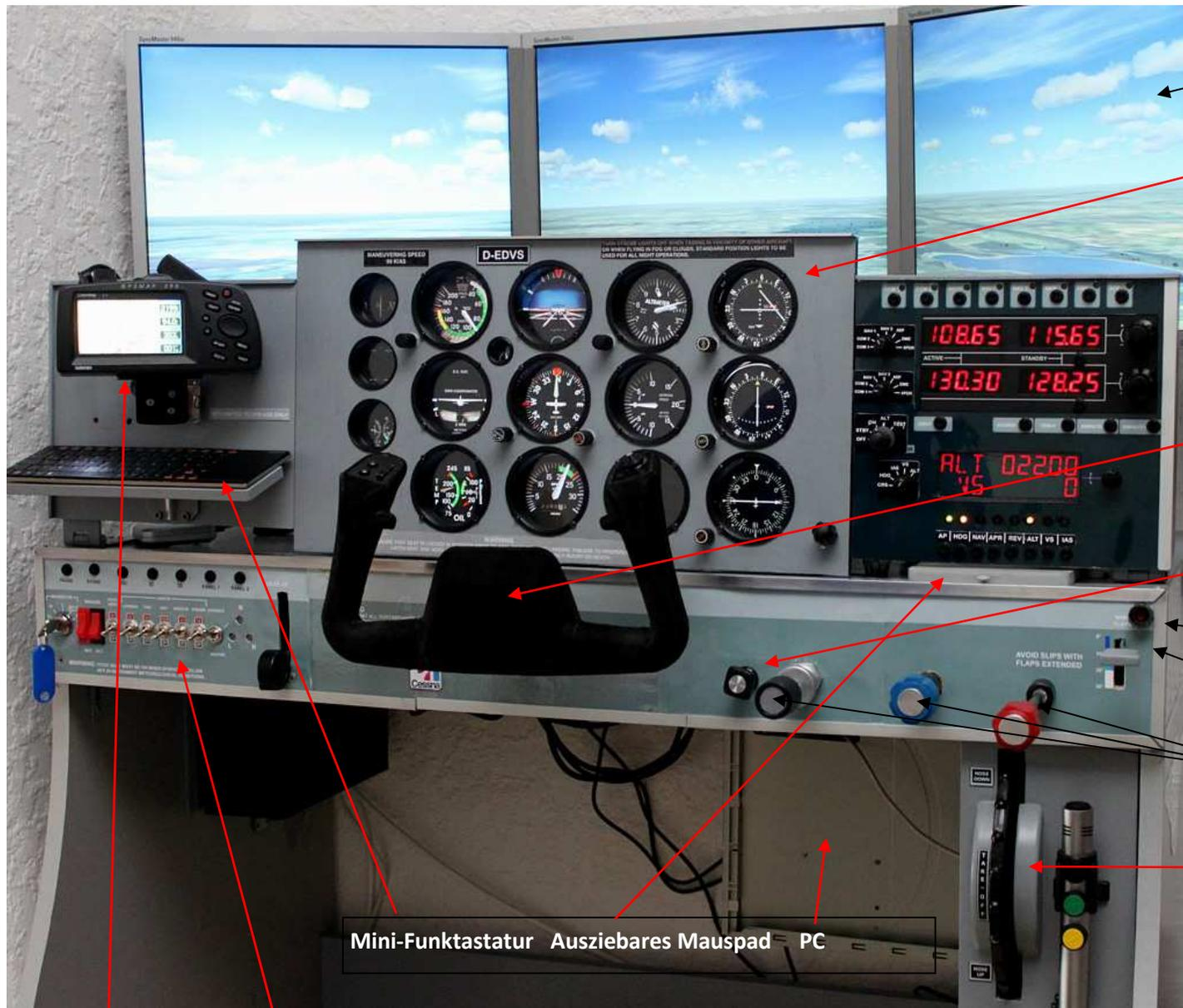
3 x 19"-Monitor, angesteuert über Matrox Triple Head DVI, Auflösung 3840 x 1024
