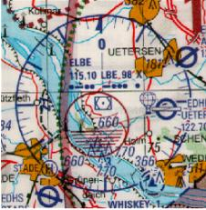
UKW - Drehfunkfeuer mit Entfernungsmessgerät (DME) hier im Beispiel:
